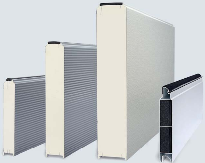
Thermisch getrennte, doppelwandige Stahl-Sandwich-Lamellen in drei Stärken: 42, 67 und 100 mm, Acoustic-Lamelle
